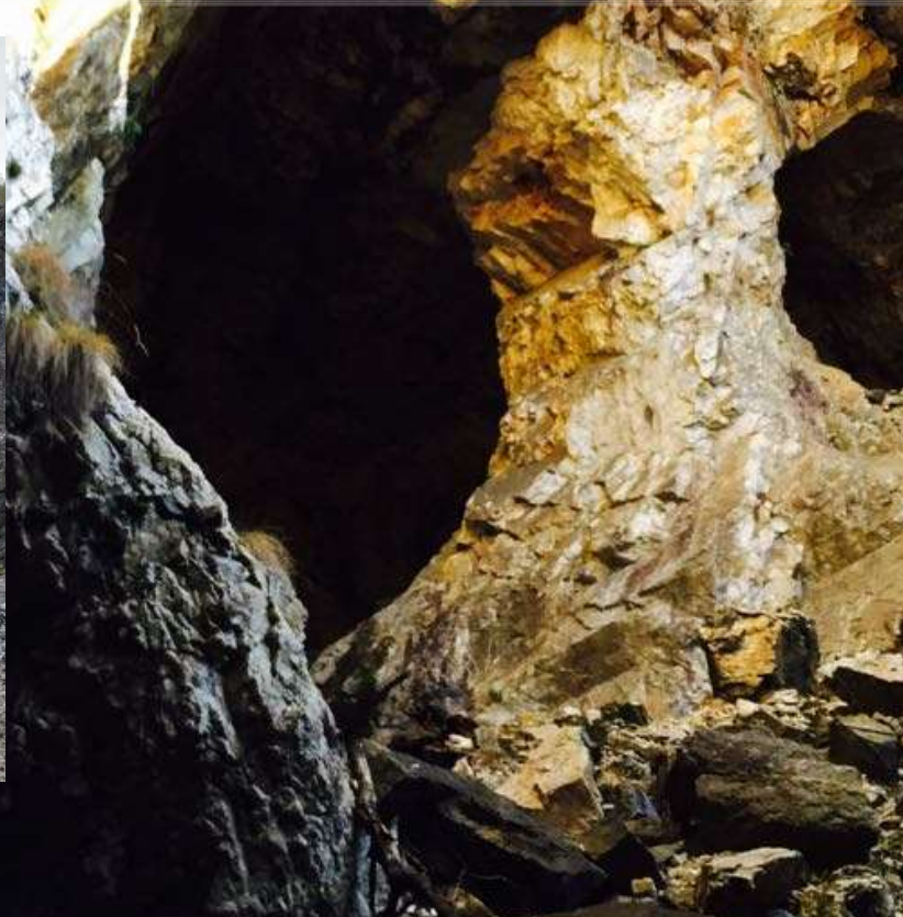
Nella foto grande: pilastri lasciati a sorreggere la volta nella cava di Quarzite delle Grange Piane, Cavallaria (Brosso).
